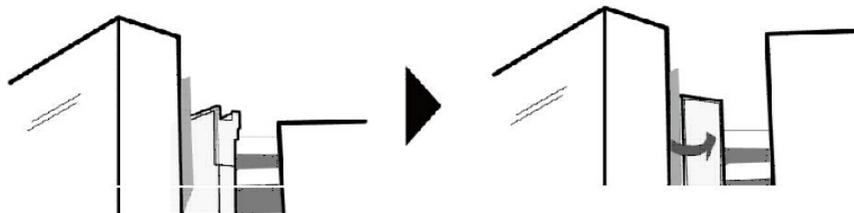
**AVISO:** Há um elemento de aquecimento elétrico na viga intermediária para proteger o orvalho. É normal quando está quente e não afeta a função de refrigeração.
